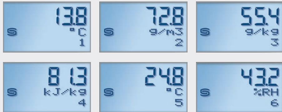
La valeur d'affichage dépend du système d'unités réglé. La température réelle et l'humidité réelle (humidité relative) s'affichent en alternance par défaut.
