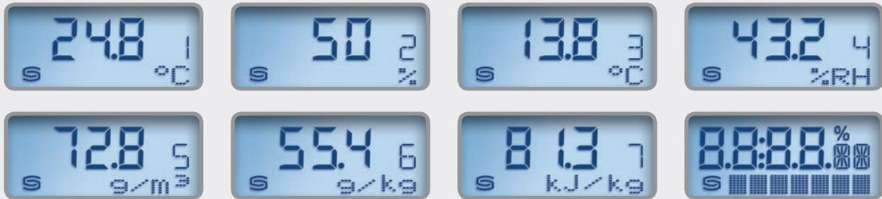
La valeur d'affichage dépend du système d'unités réglé. La **température réelle** et l'**humidité réelle** (humidité relative) s'affichent en alternance par défaut.
