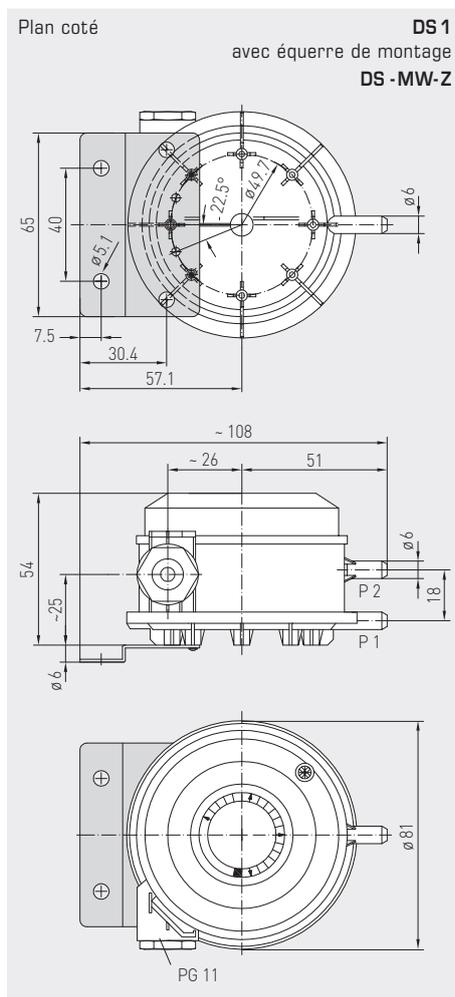
**FONCTIONNEMENT** Le contact 1 - 2 s'ouvre lorsque la pression / pression différentielle augmente et atteint la valeur réglée. Le contact 1 - 3 se ferme lorsque la pression / pression différentielle descend et peut être utilisé comme contact d'indication.
